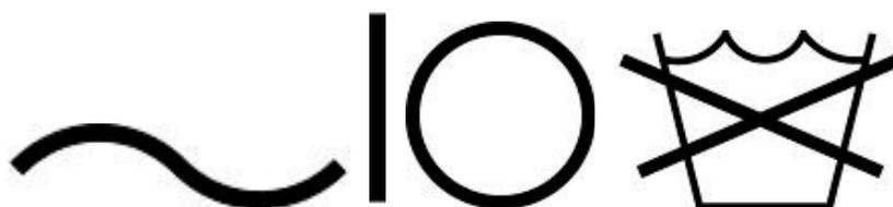
Note sulle macchine: Corrente alternata (alimentazione), "ON" (alimentazione), "OFF" (alimentazione), Non lavare o pulizia a umido
